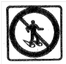
Pictogramme 246 INTERDIT L'ACCÈS AUX RAQUETTEURS Dimensions 30 cm X 30 cm Cadre: noir Fond: blanc Couronne et barre: rouge Dessin: noir
