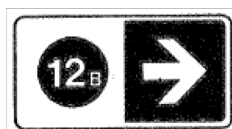
Pictogramme 210 PANNEAU - Doit avoir un minimum de 2 fenêtres - Doit contenir au moins un symbole et une flèche Couleur fenêtre gauche blanche fenêtre de droite fond bleu avec bordure blanche Dimensions 16,0 cm (hauteur) 31,4 cm (longueur)
